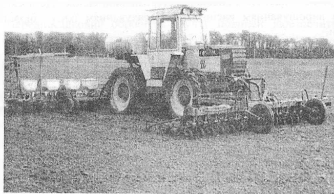
Рис. 4. Загальний вигляд агрегату в складі трактора ХТЗ-121, ґрунтообробної машини АРВ-8,1-0,1, сівалки ССТ-18В і обприскувача ОП-2000
