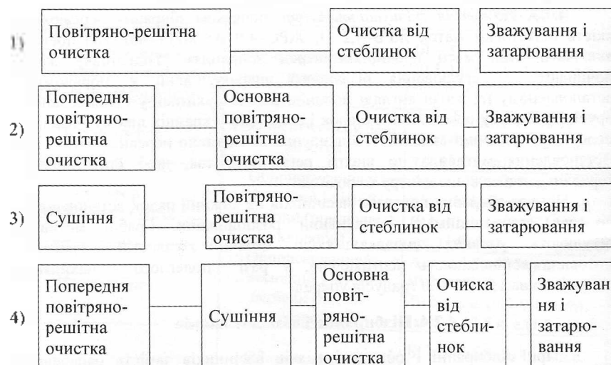
Рис. 7. Технологічні схеми післязбиральної очистки вороху насіння
